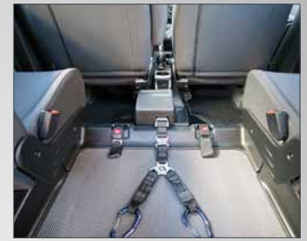
F-WINCH Disponibile in optional assiste l'ingresso della persona in carrozzina sulla rampa d'accesso
